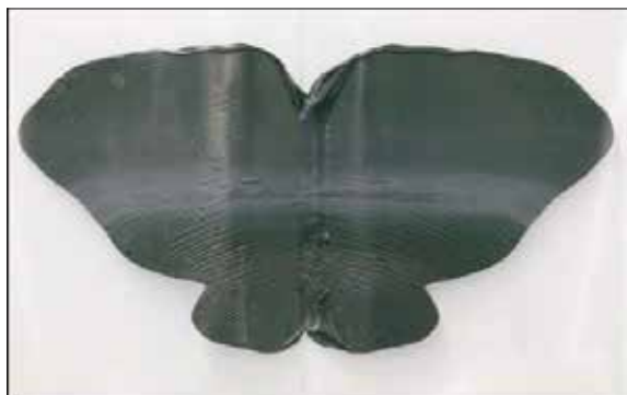
Рис. 12: негативный результат = недостаточное смешивание (тест „бабочка“)
