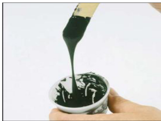
Рис. 13: материал показывает пастообразное поведение: время жизнеспособности еще не завершилось.
