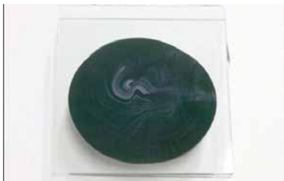
Рис. 10: негативный результат = недостаточное смешивание („мраморный“ тест)
