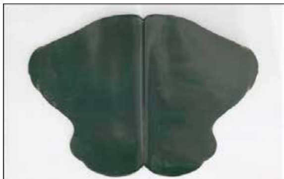
Рис. 11: положительный результат = идеальное смешивание (тест „бабочка“)
