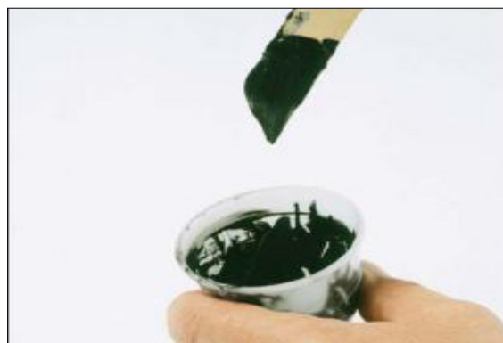
Рис. 14: материал демонстрирует поведение резины: время жизнеспособности завершилось.
