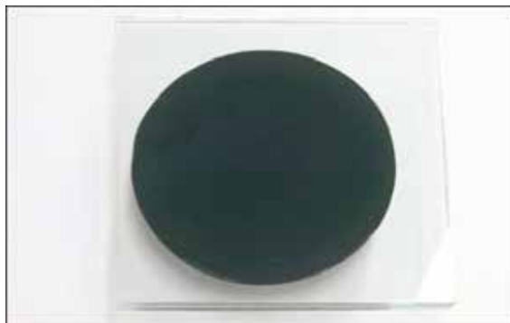
Рис. 9: положительный результат = идеальное смешивание („мраморный“ тест)
